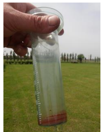
Figure : Les appareils qui se trouvent à l'extérieur sous la pluie se recouvrent après quelques temps d'une boue rougeâtre remplie de métaux. D'où cela vient-il et quel est l'effet sur les arbres et le sol ?
